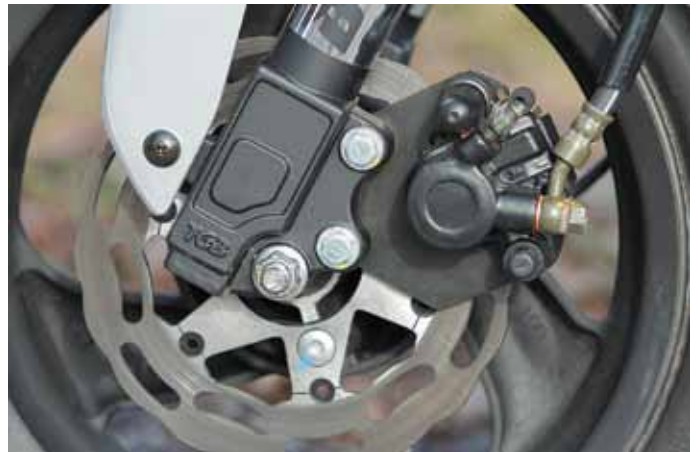
Wave-Bremsscheibe vorn mit stattlichen 220 mm Durchmesser
