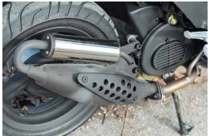
Rennsportlicher Zweitakt-Auspuff, mit Edelstahlkrümmer
