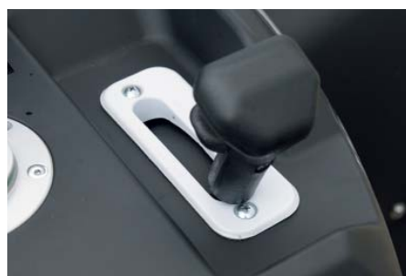
Bergführer: Der Wahlschalter bringt das Getriebe sogar in "L".
