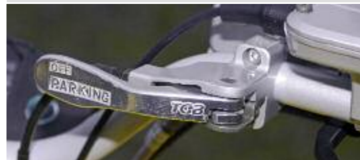
Feststellbremse: Der Klapphebel bedient den Kombisattel der Hinterachse-Bremse
