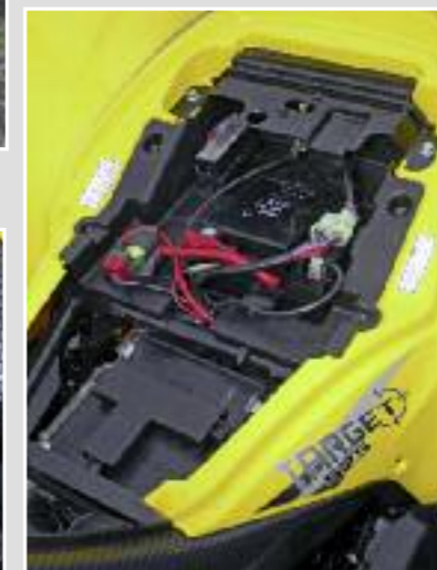
Offene Elektrik: liegende Starterbatterie unter der abschließbaren Sitzbank
