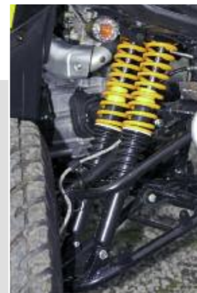
Gewichtige Optik: doppelte Heavy-Duty-Federbeine an der Target-Vorderachse
