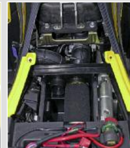
Ansaugtrakt: Beengter Luftfilterkasten mit Schaumstoffeinsatz
