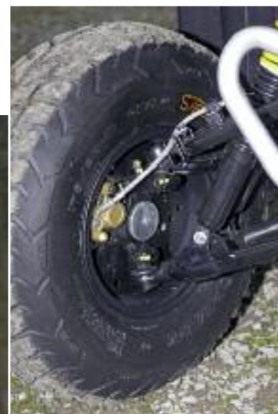
Baukasten: Achsschenkel wie beim Allradler
