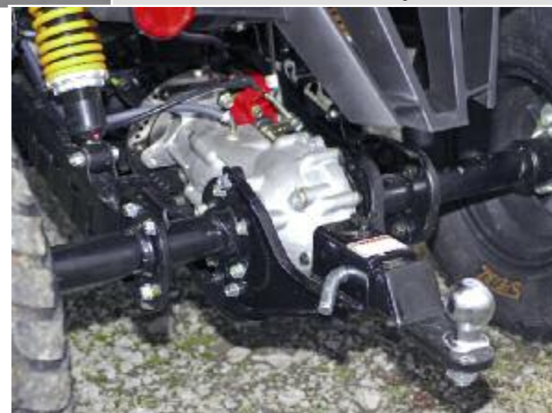
Kombiniert: Achsgetriebe mit Scheibenbremse
